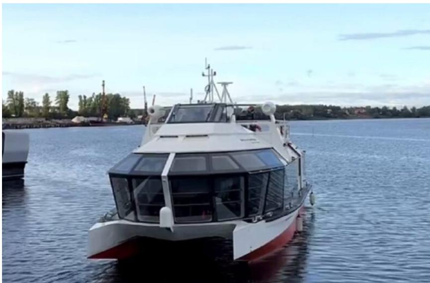
*Рис. 5. Водородное судно отечественной компании Sitronics*
