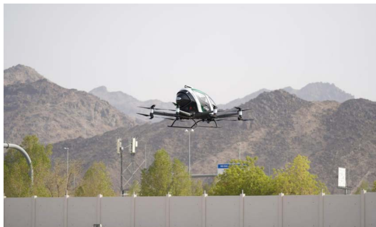
Рис. 7. Электрический аэромобиль EH216-S eVTOL
