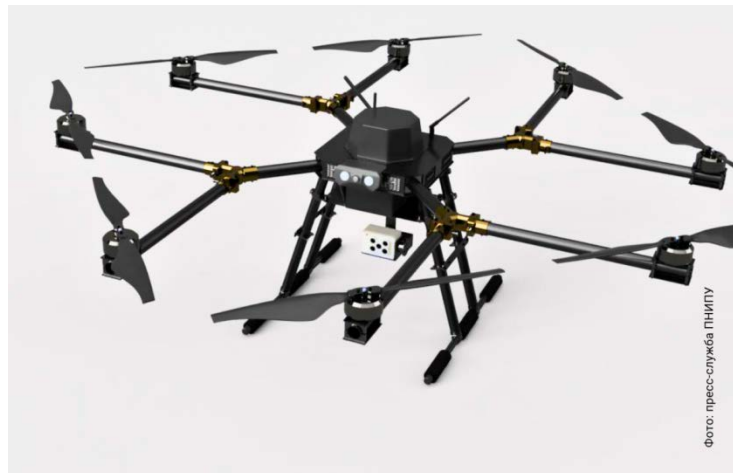
Рис. 8. БПЛА с мультиспектральной камерой
