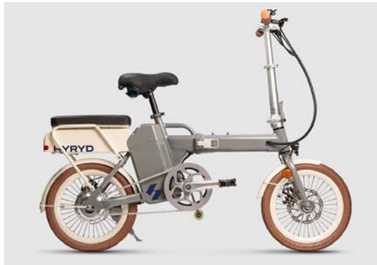
Рис. 25. Велосипед на водородных топливных элементах
