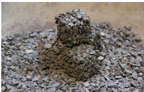
Рис. 20. Улучшающий качество окружающей среды бетон
