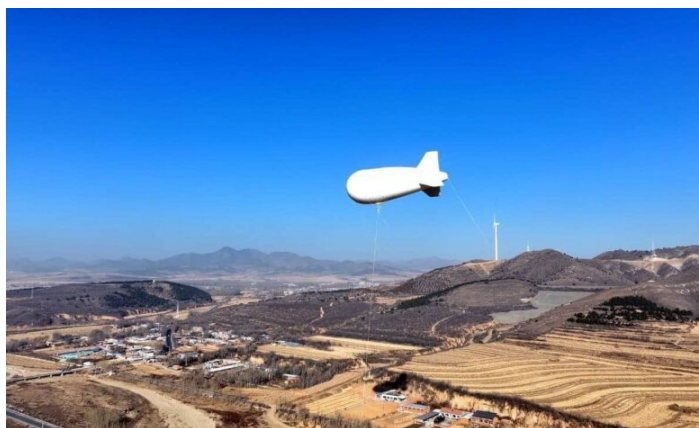
Рис. 10. Первый электрический аэростат для мониторинга инфраструктуры
