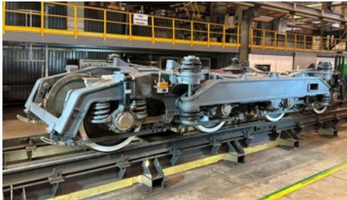
Рис. 3. Тележка для нового магистрального тепловоза 2ТЭ35А
