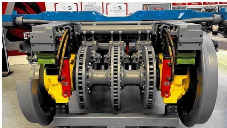
*Рис. 4. Новая тележка для высокоскоростных поездов*
