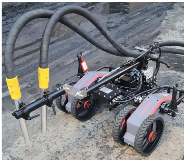
*Рис. 12. Робот для абразивоструйной очистки на судоремонтных проектах*
