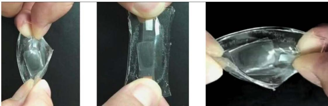
*Рис. 22. Растягивающаяся в 50 раз литий-ионная батарея*
