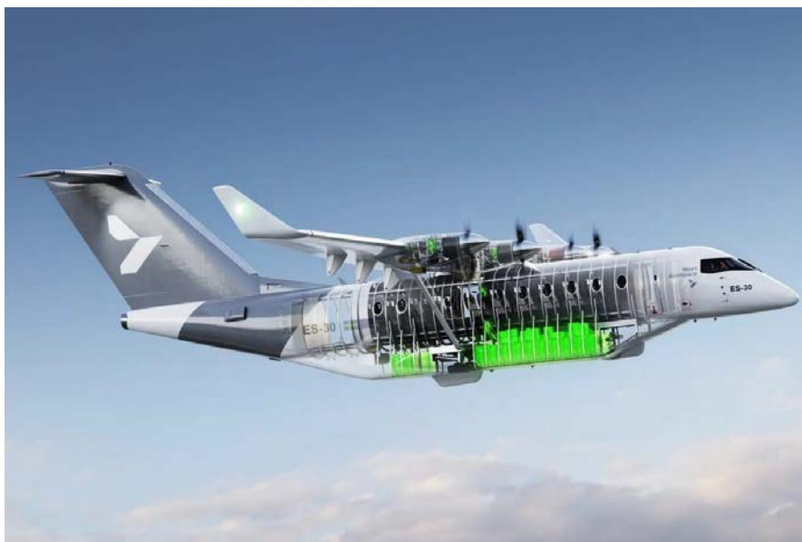
Рис. 6. Размещение аккумуляторных батарей в самолете ES-30
