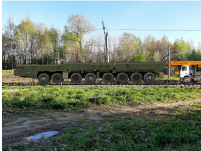
Рис. 2. Конструкция для постановки любых колесных транспортных средств на рельсовый комбинированный ход
