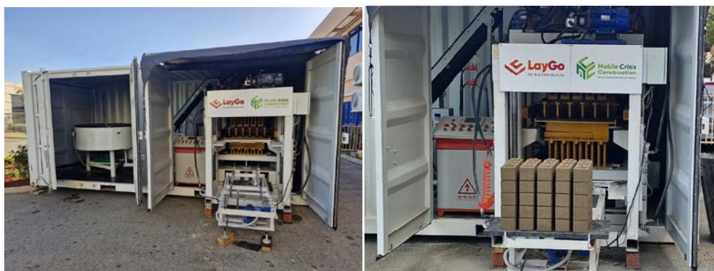
Рис. 18. Мобильная фабрика помещается внутри транспортного контейнера
