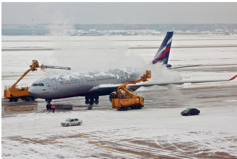
Рис. 6. Противообледенительная обработка самолета Airbus A330-200 компании «Аэрофлот» в аэропорту Шереметьево
