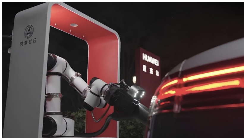
Рис. 32. Инновационная станция для зарядки электромобилей с роботизированными манипуляторами
