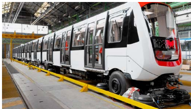
Рис. 2. Беспилотный поезд Metropolis нового поколения на шинном ходу
