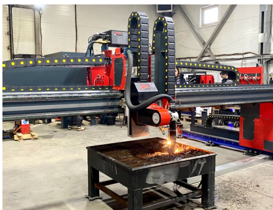
Рис. 26. Новый станок термической 3D резки металла
