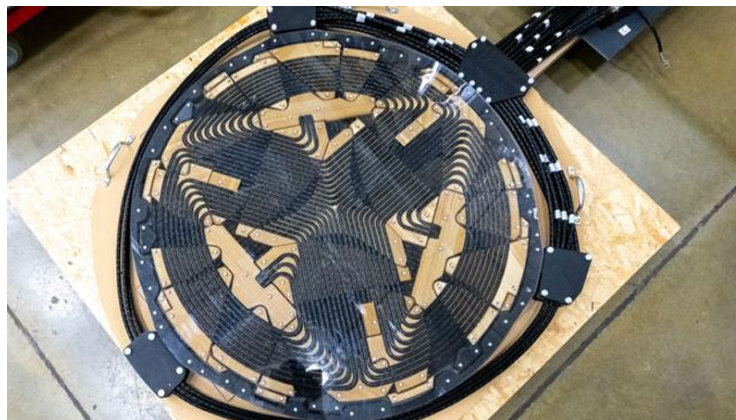
Рис. 9. Передающая питание без проводов катушка
