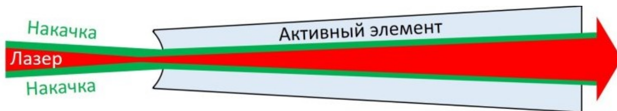
Рис. 20. Геометрия стержневого «усилителя расходящегося пучка». Изображен активный элемент и распространение пучков накачки и лазера в нем
