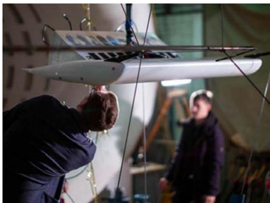
*Рис. 8. Испытания тематической модели отсека крыла с импеллерной распределенной силовой установкой*
