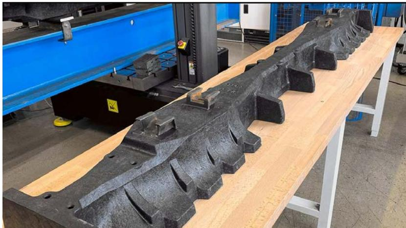
*Рис. 1. Инновационная гибридная шпала KLP модификации 104 сложной формы*
