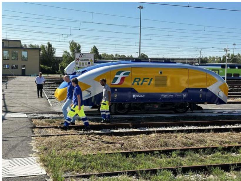
*Рис. 3. Беспилотный диагностический комплекс RFI*
