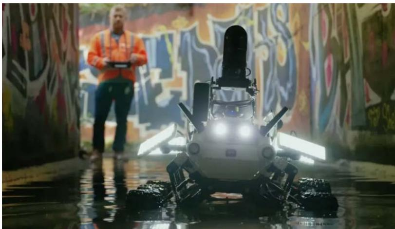
*Рис. 16. Шестиколесный робот PIPE-i*
