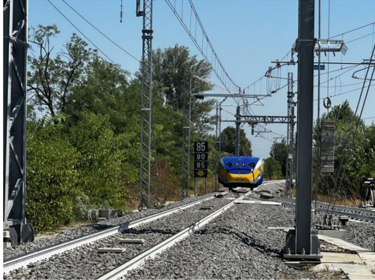
*Рис. 2. Беспилотный диагностический комплекс RFI на линии Болонья – Сан-Дonato*
