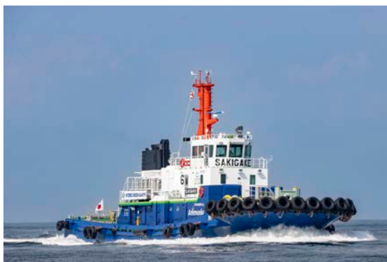
Рис. 12. Коммерческое судно, работающее на аммиачном топливе
