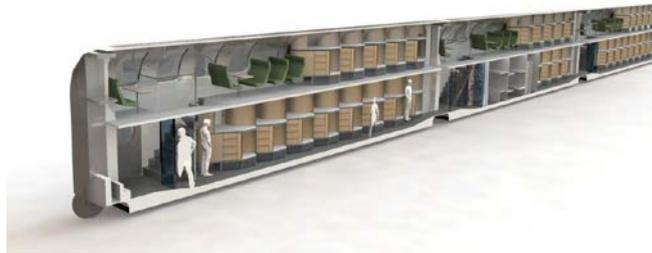
*Рис. 5. Рендер двухэтажного вагона «Sleep in Motion» от Skoda Group*
