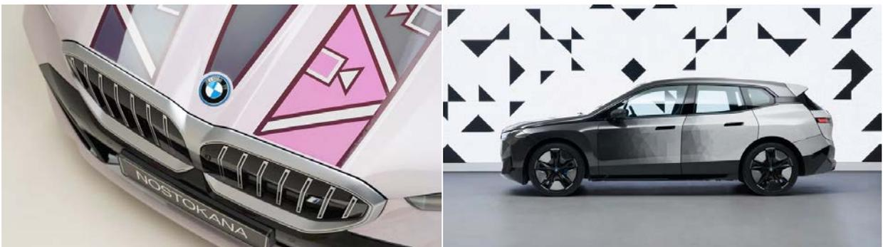
*Рис. 10. Технология изменения цвета автомобилей BMW на основе электронных чернил*
