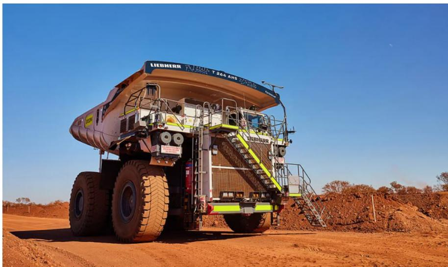
*Рис. 14. Автономный самосвал Fortescue*
