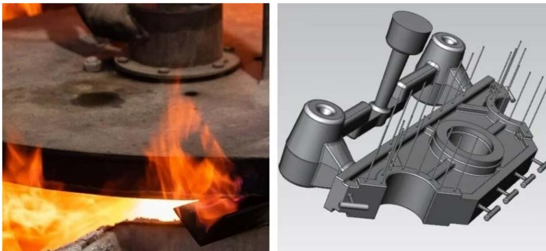
*Рис. 15. Новая технология отливки слиповой лебедки*
