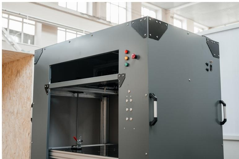
*Рис. 15. Стационарная установка термоакустического контроля дефектов полимерных композиционных материалов для авиационной и космической отраслей промышленности*
