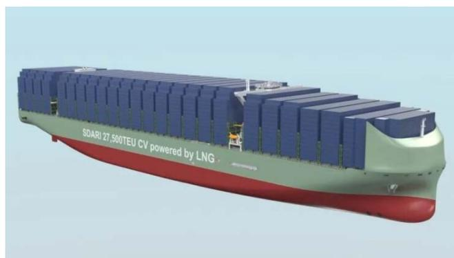
*Рис. 12. Двухтопливный контейнеровоз на сжиженном природном газе (СПГ)*
