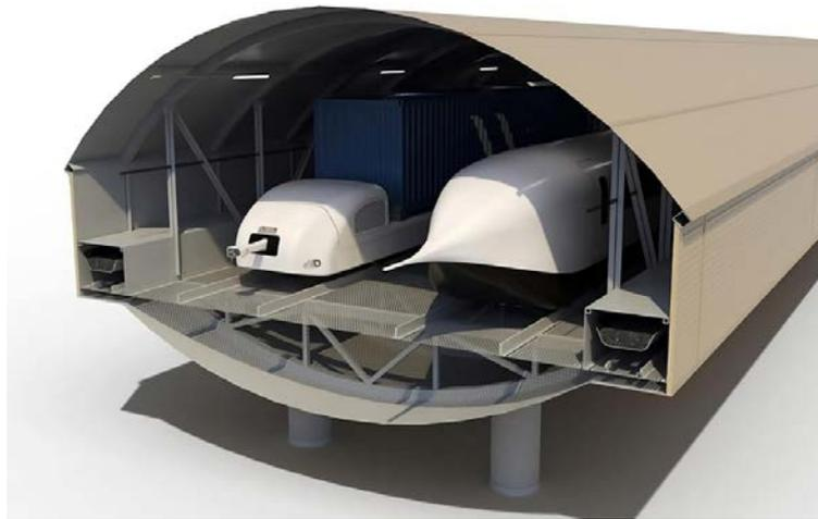
Рис. 2. Визуализация воздушного тоннеля мембранного типа с пассажирским и грузовым юнимобилями (вариант)
