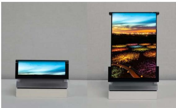
*Рис. 21. Сворачивающийся смартфон Samsung*
