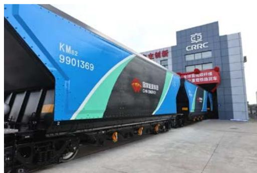
*Рис. 8. Грузовой вагон с кузовом из углеродного волокна от CRRC*
