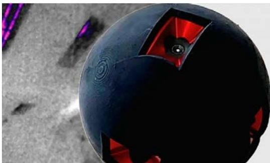
*Рис. 25. Первая в мире тактическая видеокамера, которую можно бросать из-за укрытия*
