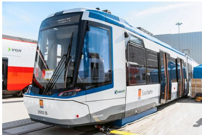
*Рис. 2. Трехсекционный низкопольный вагон CITYLINK*
