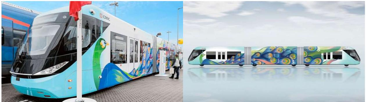
*Рис. 4. Инновационный беспилотный вагон ART 2.0 на пневматическом ходу*
