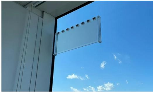
Рис. 13. Прозрачная 5G-антенна «WAVEANTENNA»
