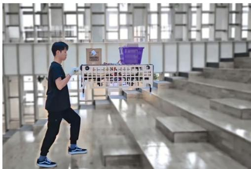
*Рис. 16. Летающая платформа для перемещения грузов без контакта с полом*
