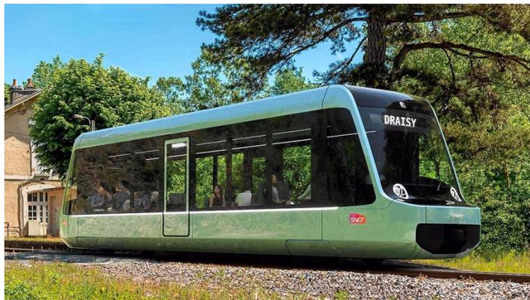
*Рис. 2. Модель рельсового автобуса с тяговыми аккумуляторными батареями*
