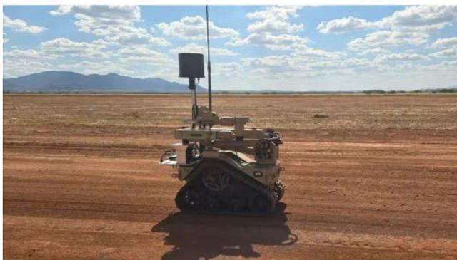
*Рис. 24. Робот с новой системой радиоэлектронной борьбы*
