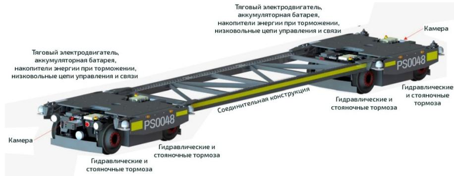
Рис. 4. Конструкция автономного экипажа Mark 2
