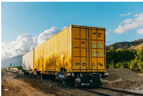
*Рис. 3. Контейнеры на беспилотных экипажах Parallel Systems*
