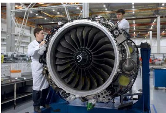
*Рис. 8. Двухконтурный турбовентиляторный двигатель ПД-8*
