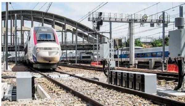
*Рис. 2. Технология KinetiX для автоматического инспектирования пассажирских поездов*
