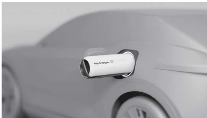
*Рис. 26. Установка контейнера в бак*
