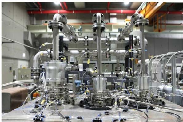
Рис. 24. Криогенный турбодетандер для сжижения воздуха
