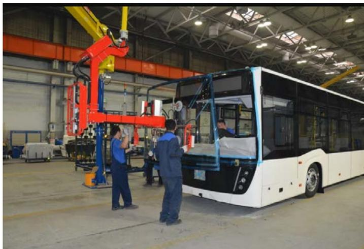
*Рис. 4. Монтаж лобовых стекол автобусов на «НЕФАЗе»*
