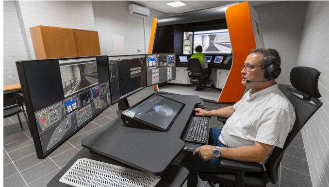
Рис. 2. Тренажер нового поколения для обучения машинистов управлению поездами семейства Metropolis
