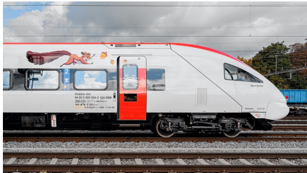
Рис. 1. Модернизированный поезд ICN из вагонов с наклоном кузовов
