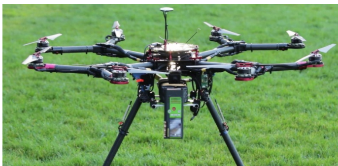
Рис. 14. БПЛА с лазерным детектором метана и видеокамерой для обнаружения с воздуха утечек природного газа
