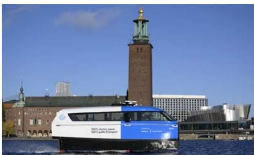
*Рис. 15. Электрический паром на подводных крыльях*
