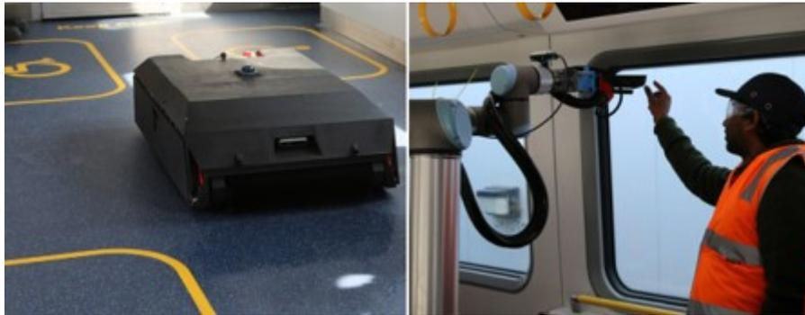
*Рис. 2. Автономные роботы для уборки подвижного состава*
