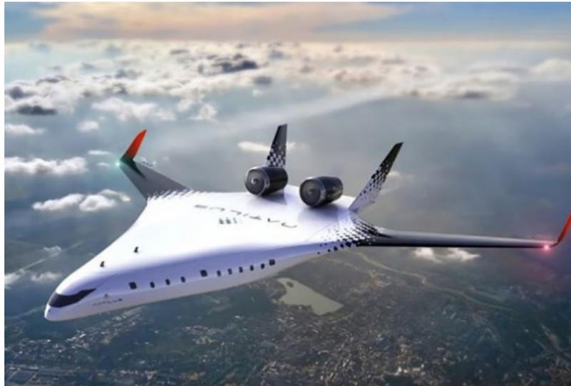
*Рис. 4. Пассажирский авиалайнер Horizon со смешанным крылом*
