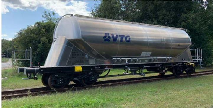
*Рис. 1. Грузовой вагон модели Uacns P81.075D*
