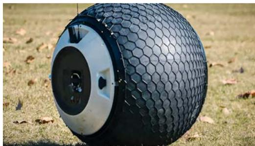
*Рис. 13. Полицейский робот Rotunbot RT-G в виде самобалансирующейся сферы*
