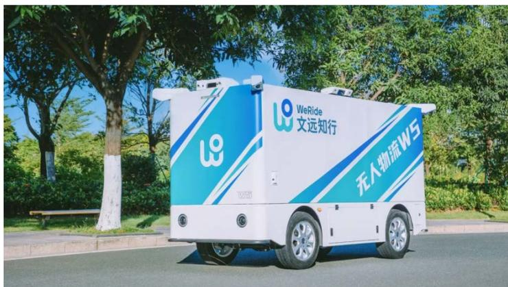
*Рис. 10. Робот-доставщик с грузоподъемностью до 1000 кг*
