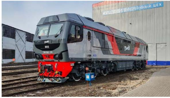
Рис. 2. Тепловоз ТЭП70БС для push-pull поезда ДП2Д
