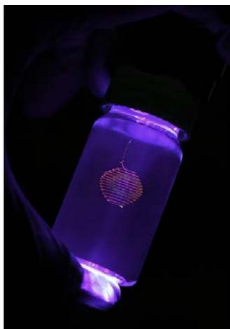
*Рис. 24. Спиральная структура, созданная с помощью встроенной 3D-печати*
