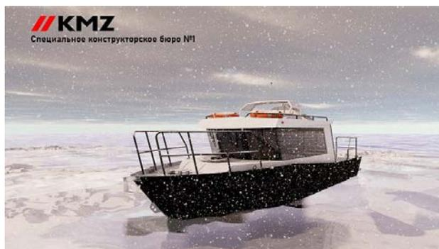
*Рис. 16. Катер-бонопостановщик «Касатка-БП»*
