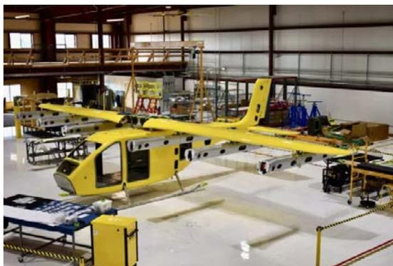
*Рис. 4. Полноразмерный прототип Gen6 в процессе сборки*
