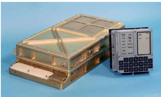
Рис. 14. Оригинальный компьютер DSKY
