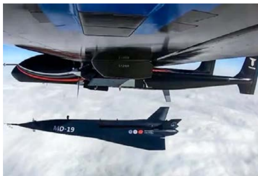
Рис. 8. Испытания двигателя с наклонным детонационным взрывом
