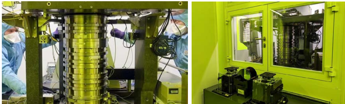
Рис. 14. Фотолитограф с разрешением 350 нм
