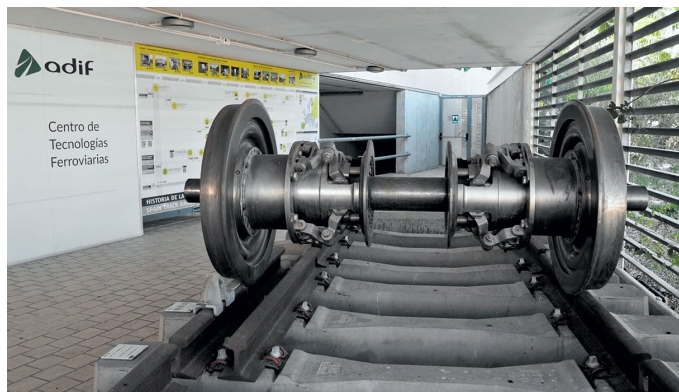
Рис. 1. Испытания установки для изменения ширины колеи грузовых поездов
