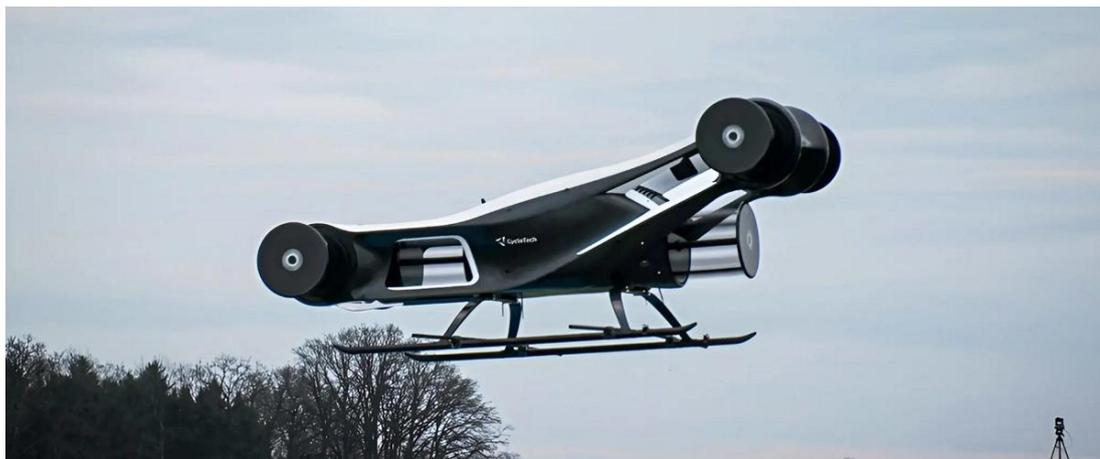
*Рис. 6. Прототип циклолета Blackbird*
