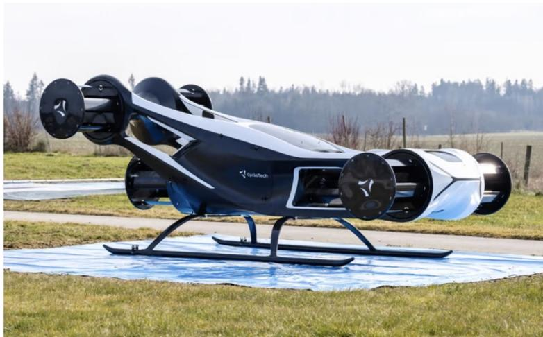
*Рис. 7. Прототип циклолета Blackbird*
