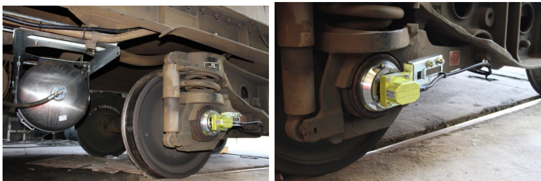
Рис. 2. Система FreightControl Sentinel, установленная на цистернах JPA для перевозки цемента
