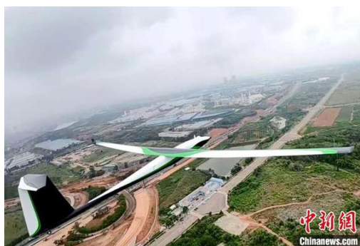
Рис. 7. Китайский беспилотник на водородном топливе
