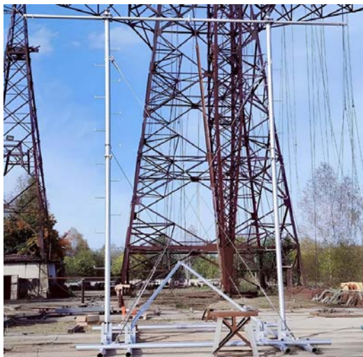
Рис. 27. Конструкция быстромонтируемой опоры
