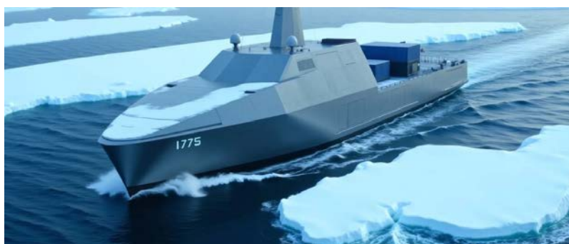
Рис. 16. Военный корабль-беспилотник водоизмещением 100 тонн
