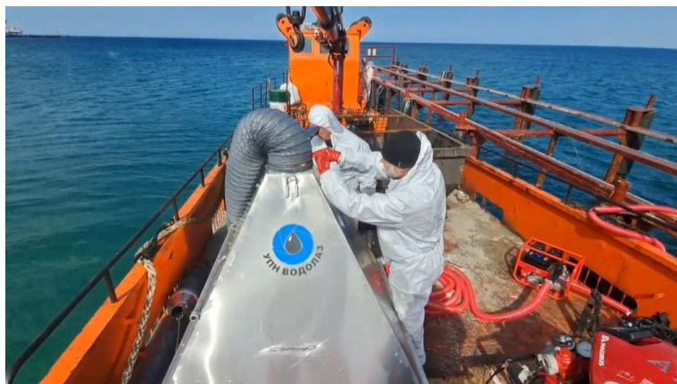
Рис. 10. УПН «Водолаз» для автоматизированного сбора мазута с морского дна
