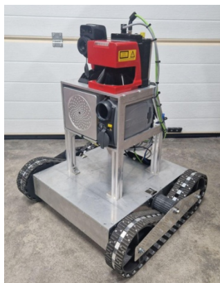
Рис. 1. Роботизированный комплекс для диагностики электроподстанций и воздушных линий электропередачи
