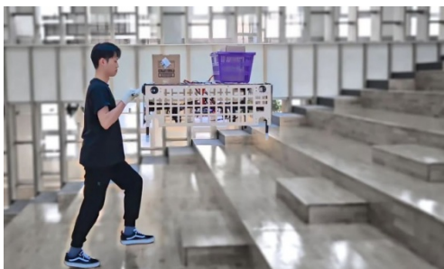
Рис. 4. Летящая грузовая тележка Palletrone
