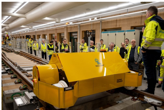
Рис. 1. Робот Railchar для диагностики железнодорожной инфраструктуры
