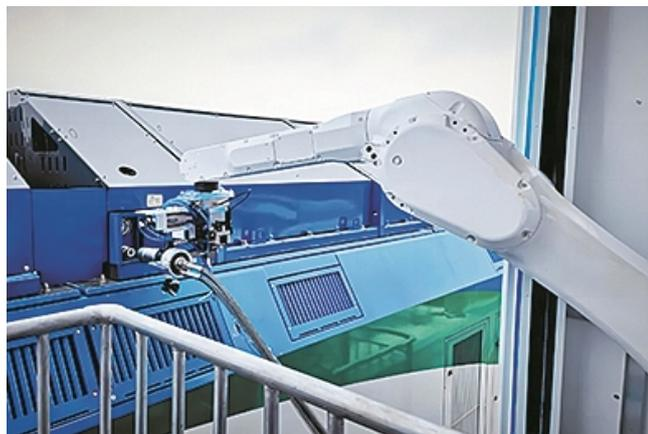
*Рис. 1. Робот для автоматической заправки водородом*
