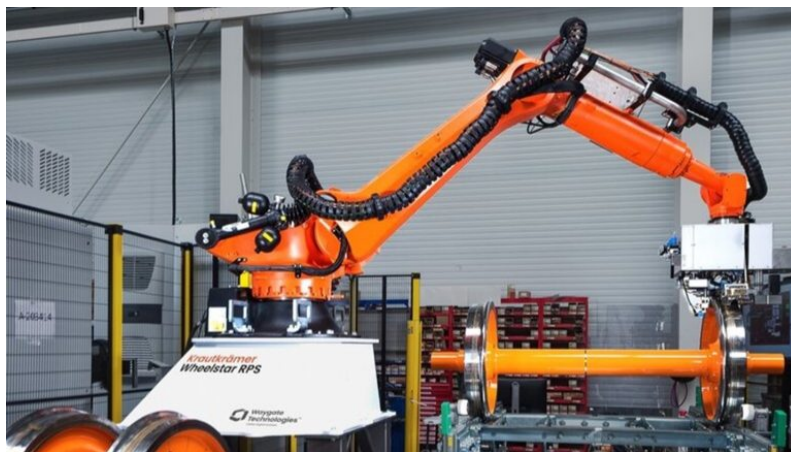
Рис. 2. Автоматизированная система ультразвуковой диагностики железнодорожных колёс Krautkrämer WheelStar RPS
