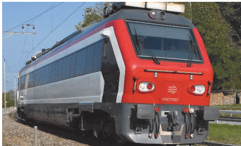
Рис. 1. Самоходный диагностический комплекс для инспектирования железнодорожной инфраструктуры
