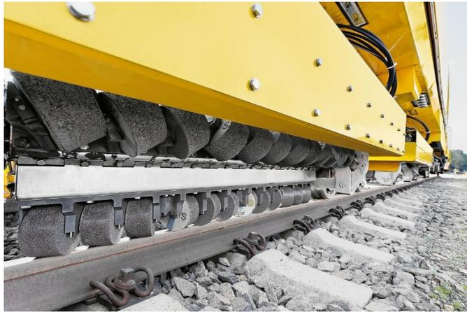
*Рис. 1. Рельсошлифовальный поезд компании Vossloh*
