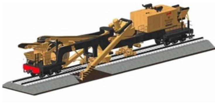
Рис. 2. Комплекс для создания подбалластного защитного слоя ЩОМ-МРС
