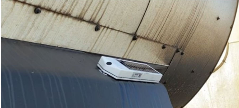
Рис. 10. Телематическое устройство, работающее на солнечных батареях
