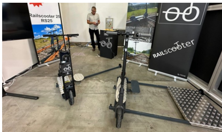
Рис. 6. Электросамокаты на рельсовом ходу для путевого хозяйства
