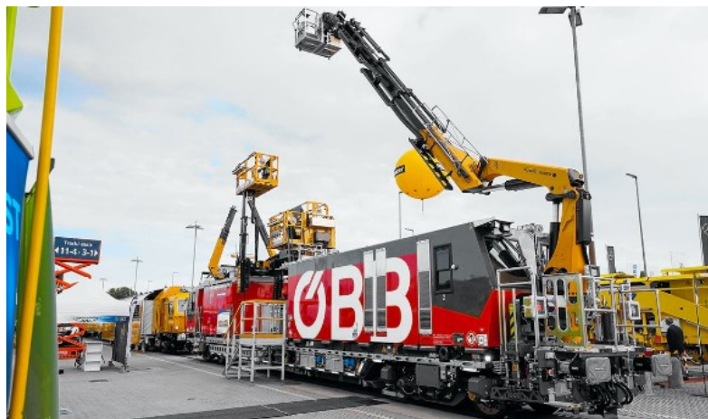
Рис. 2. Машина с гибридным приводом для инспектирования, планового обслуживания и ремонта контактной сети
