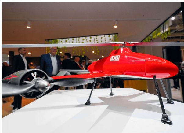
Рис. 3. Дрон для контроля за железнодорожной инфраструктурой и растительностью вблизи путей
