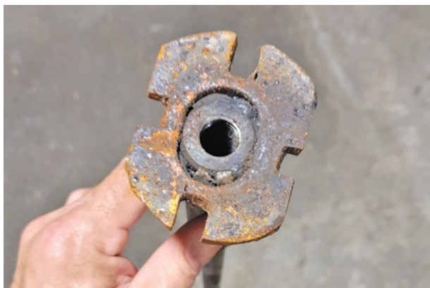
Рис. 2. Крепление, предложенное мастером, не даёт плитам расходиться
