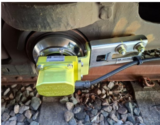
Рис. 4. Бортовая телематическая система FreightControl Sentinel, установленная на грузовом вагоне VTG
