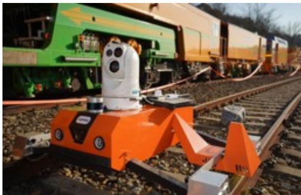
Рис. 1. Korail разработала инспекционного робота для осмотра путей
