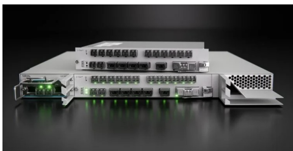
Рис. 3. Оптический терминал FSP 3000 S-Flex поддерживает различные скорости Fibre Channel и соединяет распределённые центры обработки данных Infrabel
