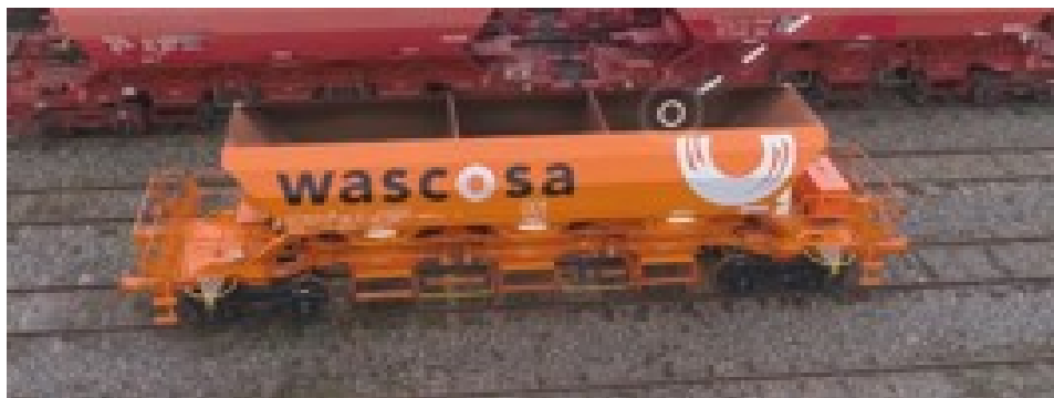
Рис. 2. Вагон хоппер-дозатор модели Fanps 2.0 с дистанционным управлением
