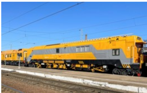
Рис. 1. Рельсоукладочный комплекс РУ-700
