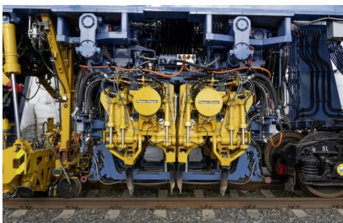
Рис. 2. Цифровизированный, полностью автоматизированный процесс трамбовки снижает нагрузку на обслуживающий персонал и обеспечивает стабильные результаты
