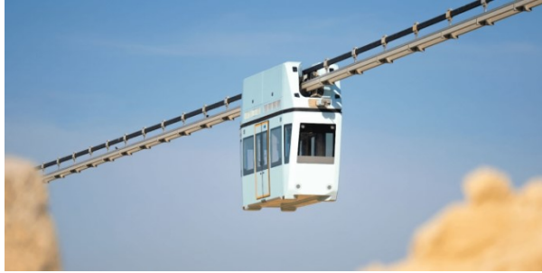
Рис. 1. Флагман компании UST Inc. 25-местный юнибус «Карат» U4-212 на полугибком струнном рельсе
