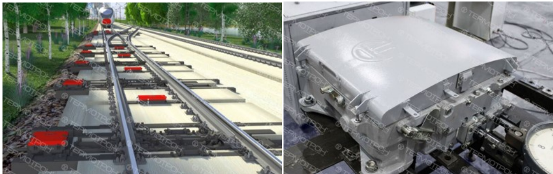
Рис. 1. Стрелочный высокоскоростной привод ВП-400 и устройства контроля УК-400
