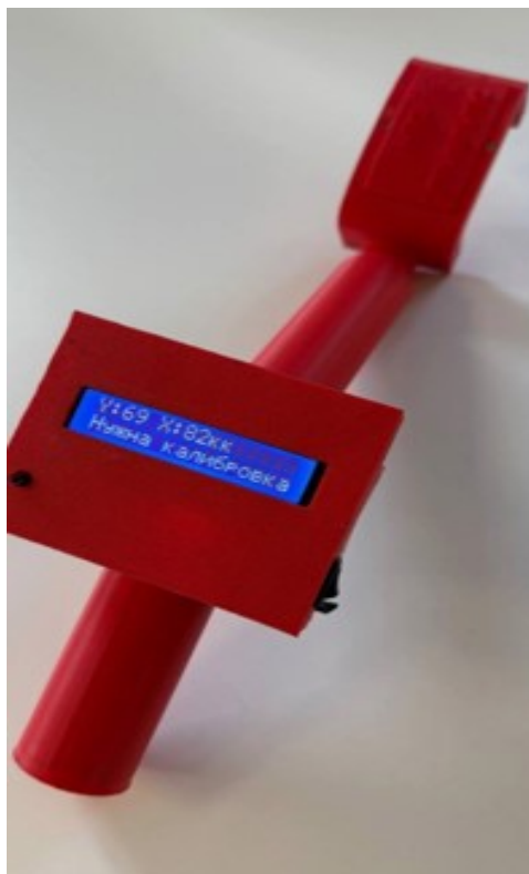
Рис. 2. Прибор для измерения бокового и вертикального износов рельсов
