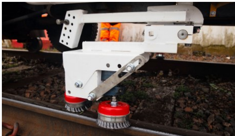
Рис. 3. Специализированный поезд для очистки пути от листьев
