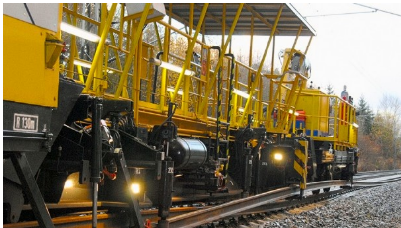
Рис. 2. Поезд для замены рельсов компании Vossloh
