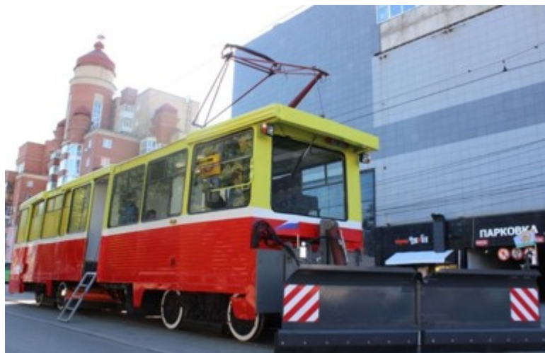
Рис. 2. Снегоочиститель был создан специалистами городского перевозчика «ЧелябГЭТ» путем модернизации высокопольного трамвая КТМ 71-605
