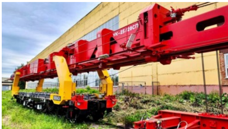
Рис. 3. Укладочный кран УК-25/28 СП
