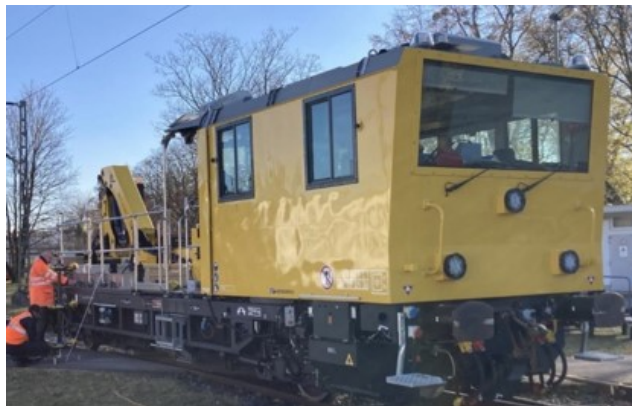
Рис. 7. Четырехосная самоходная автомотриса класса 745.0 GAF
